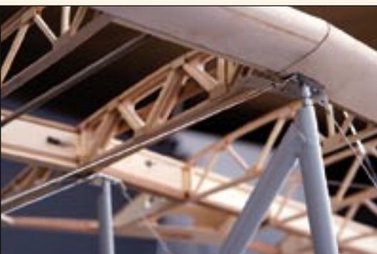
Der Baldachin besteht aus profilierten Edelstahlrohren, in den Enden befinden sich Gewindeeinsätze. Gut zu sehen auch die Blechbeschläge zur Aufnahme der tragenden Verspannung
