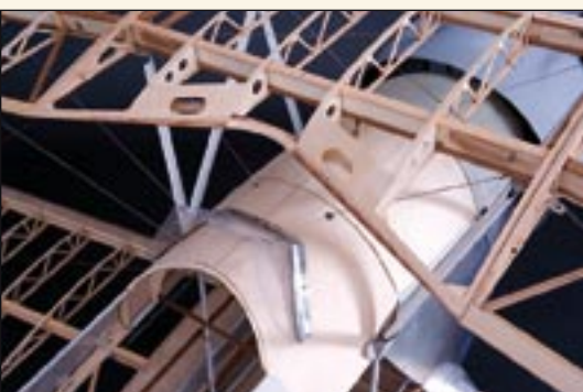
Das Tragflächenmittelstück ist wie die Tragflächen aufgebaut, wobei die Rippen von der Nasenleiste bis zum hinteren Kastenholm identisch mit den Flächenrippen sind
