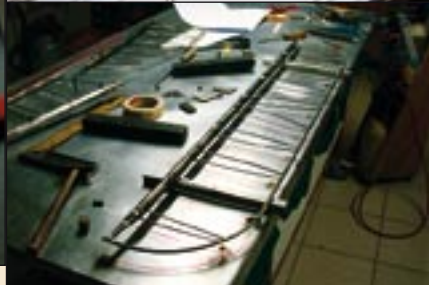
Die im Aufbau befindlichen Teile des Leitwerks. Zwischen Hauptholm und Nasenrohr werden profilgebende 3-mm-Edelstahlrohre eingepasst
