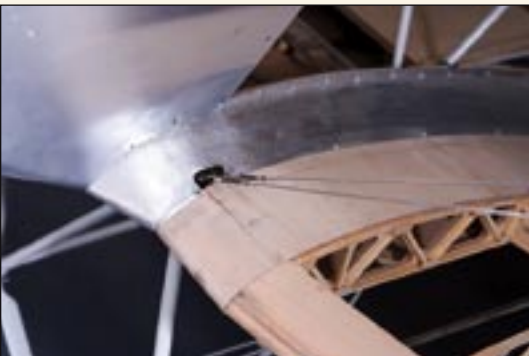
Die Verspannungen sind mit M3-Gabelköpfen an den Blechbeschlägen eingehängt, auch rumpfseitig
