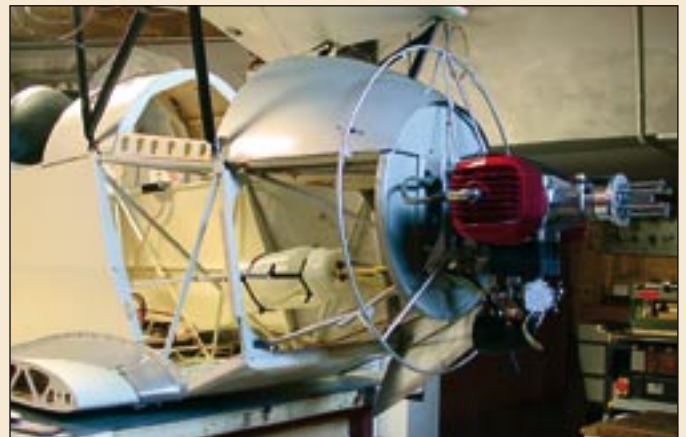
Einbau des 3W 150. Die Stahlrohre, die den Motordom mit dem Rumpf verbinden, sind Edelstahlrohre mit 1-mm-Wandstärke! Der „kleine“ Tank fasst immerhin einen Liter! Lithobleche formen die Übergänge zwischen Rumpf und unterer Tragfläche aus
