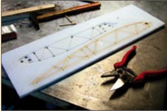
In das Nylonbrett wurden 4 mm x 4-mm-Nuten eingefräst, in die dann die Leisten eingelegt werden konnten
