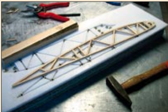
Nach Verkleben aller Einzelteile wird das Nylonbrett auf eine Vorrichtung gelegt. Ein sanfter Hammerschlag löst die Rippe aus ihrer Helling
