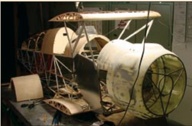
Die fertige Motorhaubenverkleidung nehmen zwei Ringe aus Edelstahlrohren auf
