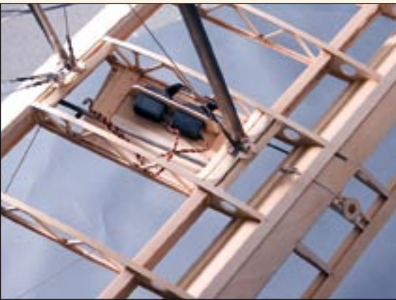
Die Querruderservos befinden sich paarweise in der unteren Fläche, die oberen QR werden über je ein Seilpaar angelenkt
