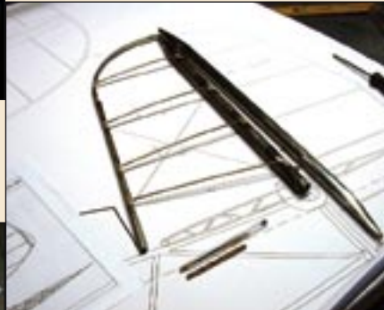
In das Nylonbrett wurden 4 mm x 4-mm-Nuten eingefräst, in die dann die Leisten eingelegt werden konnten
